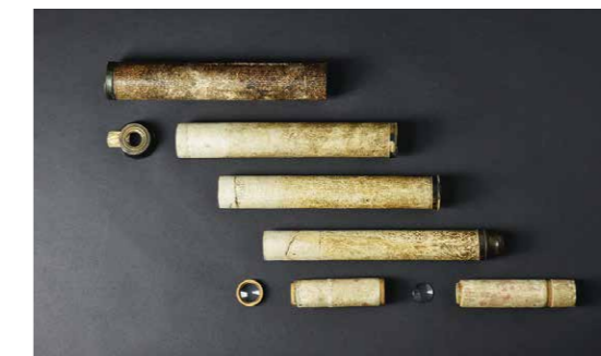
Fernrohre aus Papptuben, Glaslinsen und Holzfassungen wurden von den Schülern selbst hergestellt. Fernrohr, 18. Jh., Privatbesitz Kiel
