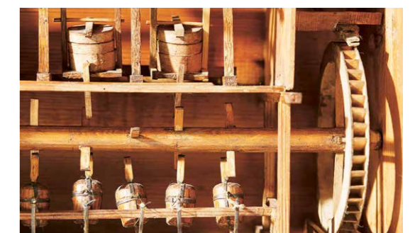
Modell einer Stampfmühle mit Wasser- und Handantrieb, vor 1741, Franckesche Stiftungen
