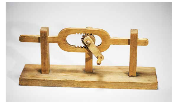
Getriebemodell aus Christopher Polhems Mechanischem Alphabet , spätes 17. Jh., National Museum of Science and Technology Stockholm
